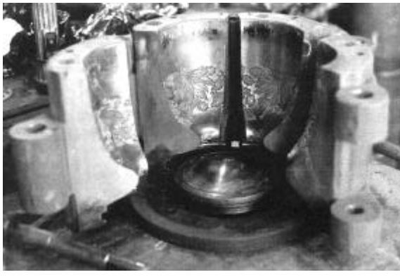
Abb. 06-2000/146 „Weihnachts-Kompott-Schale“ mit Stechpalmen-Dekor aufgeklappte Pressform, Dugan ca. 1908 aus Glass Collector's Digest 11/03-1997, S. 20
