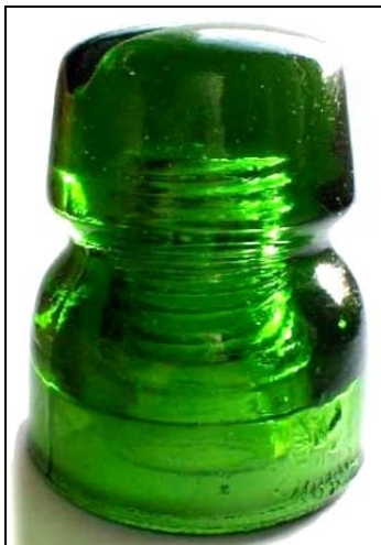
Abb. 2006-1/056 Isolator für elektrische Leitungen Pressglas, smaragd-grün [emerald green] H 7 cm [2 3/4 inches], D 5,8 cm [2 5/16 inches at the base] seitlich unten rechts eingepresster Russischer Adler mit dem Firmennamen „МАЛЬЦОВСКОЕ“ Maltsovskoje, vor 1917 aus http://www.insulators.com/pictures/?id=118593047
