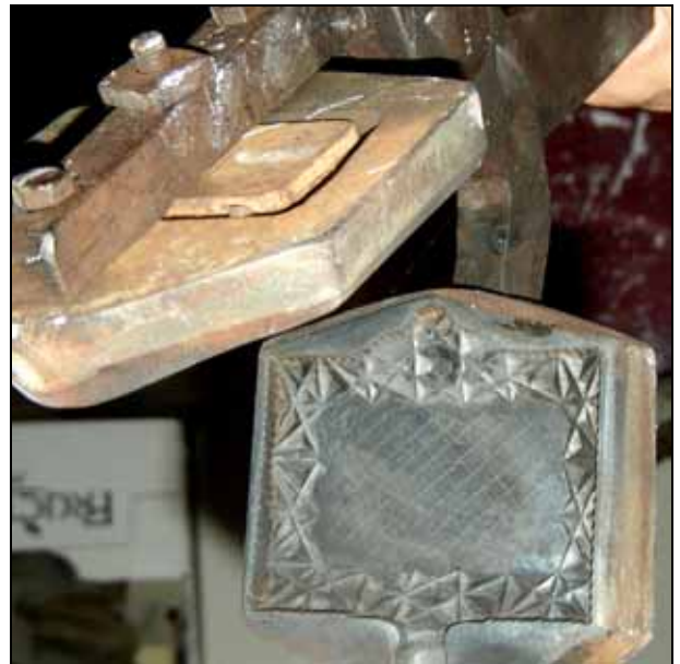
Abb. 2006-4/225 Sklářská dílna Josefův Důl - Jaroslav Pesničák, 2006-10 Drückerzange mit zwei austauschbaren Pressformen für einen Stopfen mit Pseudo-Schliff und Pseudo-Reliefgravur mit antiker Szene. Vorder- und Rückseite können getrennt verwendet werden. Die eingeritzten, quadratischen Gitter auf den größeren Flächen der Pressform sollen verhindern, dass die gepresste Glasfläche beim Erkalten und damit verbundenem „Schrumpfen“ rissig oder faltig wird, das Gitter wird später abgeschliffen, die Fläche wird poliert. Reste dieses Gitters kann man auch bei manchen Pressgläsern aus der Vorkriegszeit erkennen.
