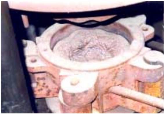
Abb. 2002-1/216 Glasfabrik Vallerýsthal 2001, Pressform in der Glaspresse Sammlung Valsar
