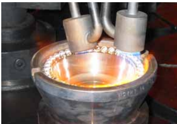
Verwärmen / Feuerpolieren von der Oberseite
