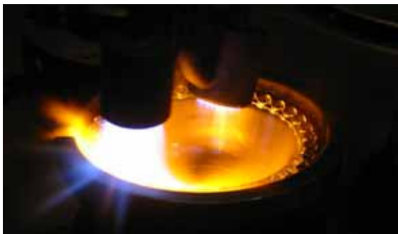
Verwärmen / Feuerpolieren von der Oberseite
