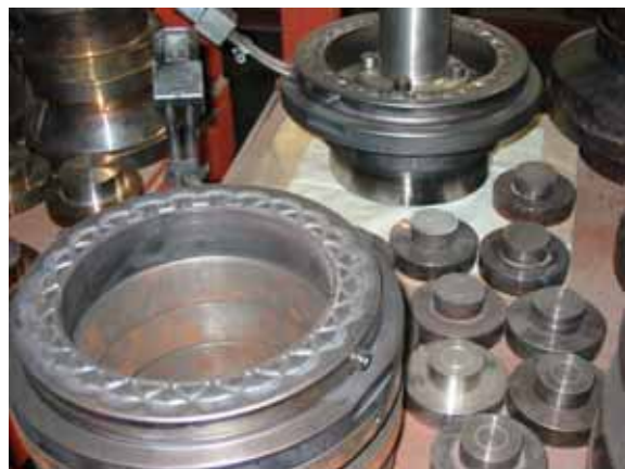
Schleuderform für eine Schale (die Form wird nicht durch einen Stempel erzeugt, sondern durch die Zentrifugalkraft der sich schnell drehenden Form mit dem „flüssigen“ Glas)
